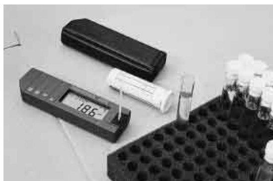
Tests rapides par bandelettes colorimétriques, sol ou plante
